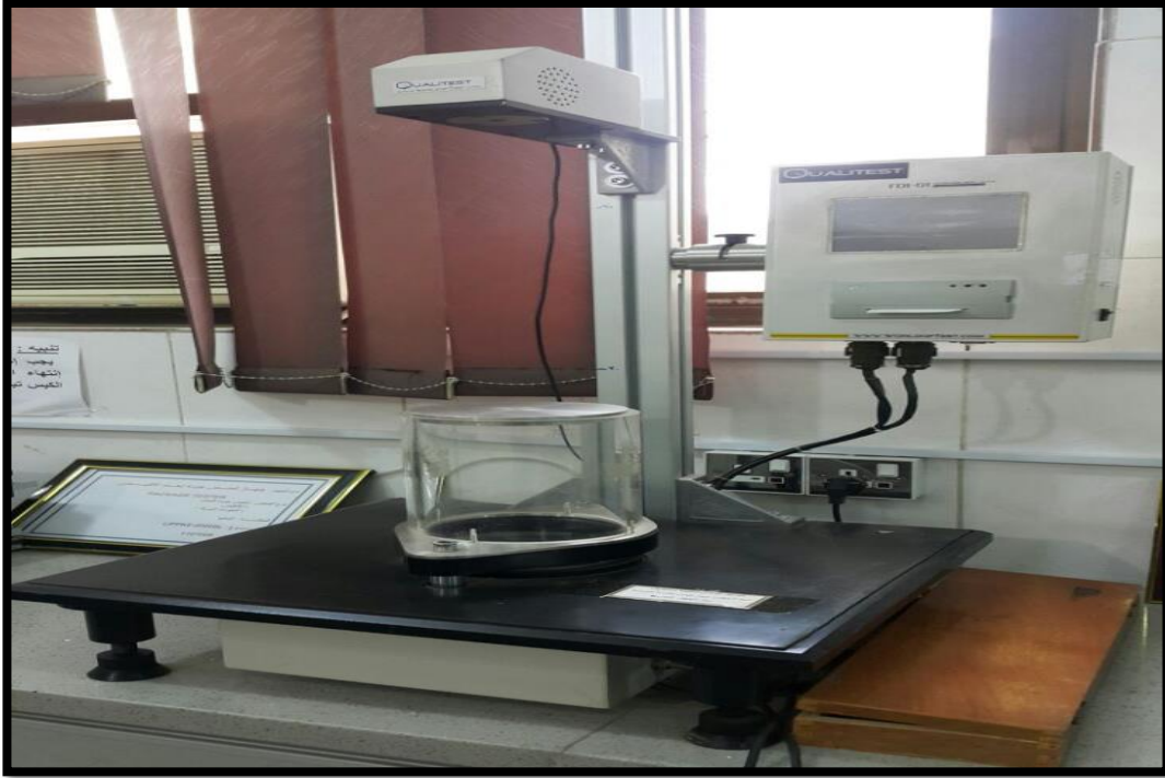
الشكل (3-12): صورة جهاز اختبار مقاومة الصدمة.
