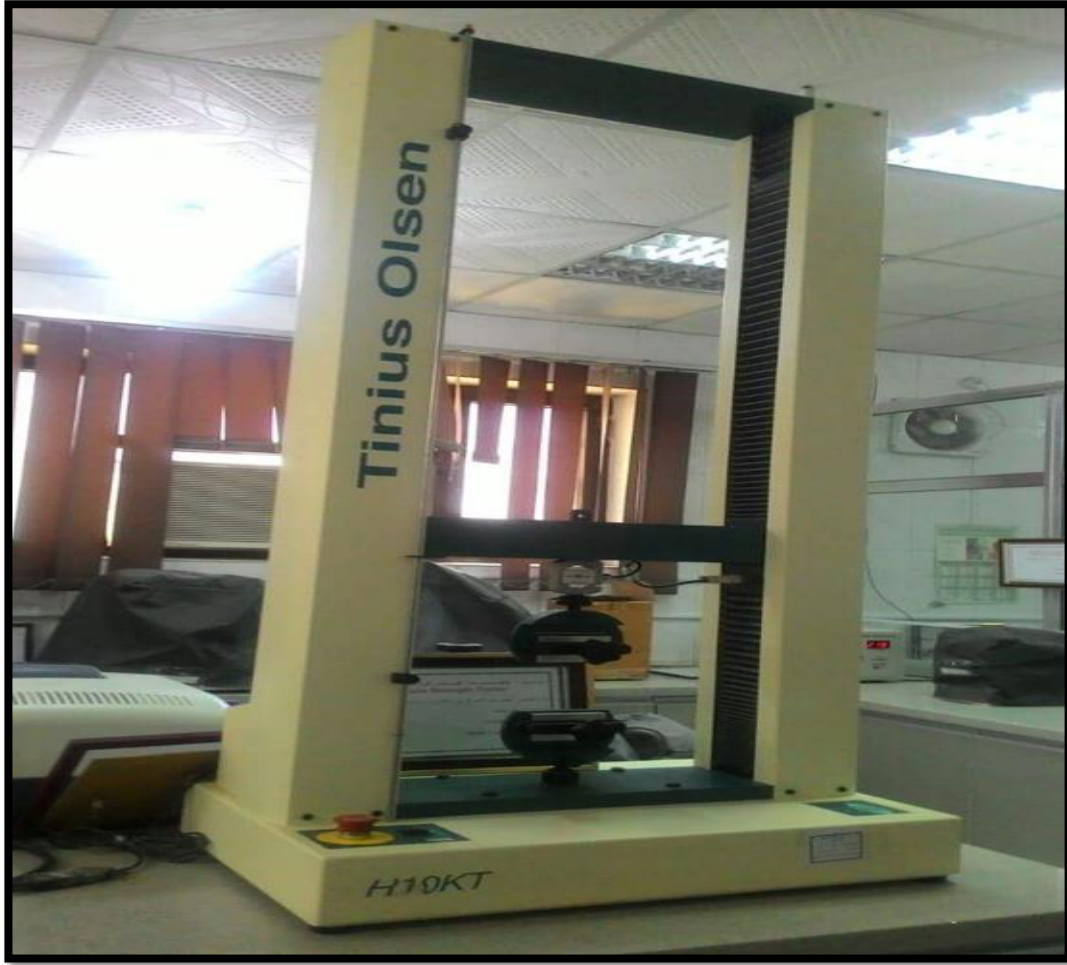
الشكل (10-3): صورة جهاز اختبار الشد.
