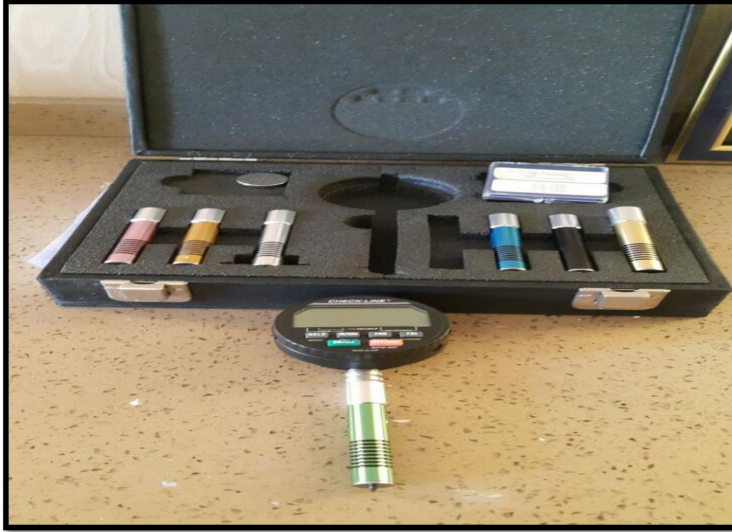
الشكل (3-11): صورة جهاز اختبار الصلادة.
